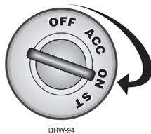
*Pour désarmer le système de sécurité, tournez la clé de contact à la position "ON".*
