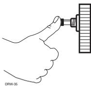
*Appuyez sur l'interrupteur à bouton poussoir selon le nombre de fois programmé dans le système (1 à 5 fois). Ce processus doit être effectué dans l'espace de 15 secondes. Après trois secondes d'attente, le système devrait se désarmer, si celui-ci ne se désarme pas, tournez la clé de contact à la position "OFF" et reprenez les étapes depuis le début.*
