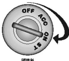
Tournez la clé d'ignition à la position "on". Appuyez sur l'interrupteur Valet dans les 15 secondes qui suivent. Le système devrait maintenant désarmer. Sinon, vous avez peut-être attendu trop longtemps, mettez la clé à "off" puis à "on" et essayez encore.
