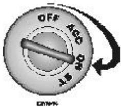
Tournez la clé d'ignition à la position "on". Appuyez sur l'interrupteur Valet dans les 15 secondes qui suivent. Le système devrait maintenant désarmer. Sinon, vous avez peut-être attendu trop longtemps, mettre la clé à "off" puis à "on" et réessayez de nouveau.
