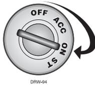
1. Insérez la clé de contact dans le cylindre et tournez-la à la position "ON" ou "RUN" et non à la position "START".
