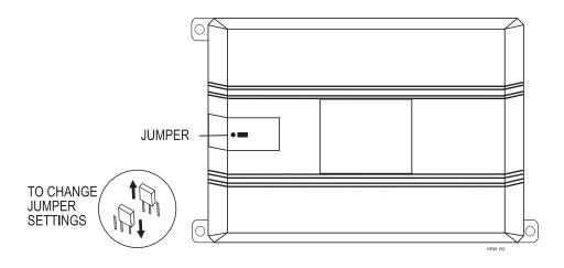
DOUBLE PULSE UNLOCK • • • SINGLE PULSE UNLOCK
