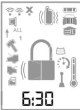
L'alarme s'arme, les portes se verrouillent (si branché), et les feux de stationnement clignotent une fois et la sirène émet une tonalité. Le texte **ARMED** s'affiche et une tonalité de confirmation se fait entendre et les icônes d'état du système se mettent à jour. Lorsque le mode Valet\* est actif, les portières se verrouillent et le texte **VALET** s'affiche accompagné d'une tonalité. Sortir du mode Valet pour armer l'alarme normalement.
