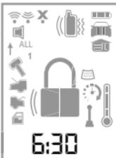
Se activa la alarma, las puertas se bloquean (si estuviesen conectadas), la sirena emite un pitido y las luces de estacionamiento parpadean una vez. Se muestra el texto **ARMED** y se escucha un pitido como confirmación y se actualizan los íconos de Estado del Sistema. Si el modo Valet\* está Activo las puertas se bloquean y aparece el texto **VALET** y se escucha un tono. Salga del modo Valet para activar la alarma en forma normal.
