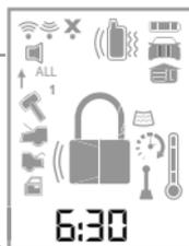
Las puertas se bloquean y suena la bocina (si estuviese conectada) y las luces de estacionamiento parpadean una vez. Se muestra el texto **LOCKED** y se escucha un pitido como confirmación y se actualizan los íconos de estado del sistema. Si el modo Valet\* está Activo las puertas se bloquean y aparece el texto **VALET** y se escucha un tono. Salga del modo Valet para Bloquear el sistema en forma normal.
