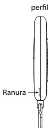
1. Utilice un destornillador de cabeza plana, insértele en la ranura y con cuidado haga palanca de modo que se abra la parte delantera de la unidad.
