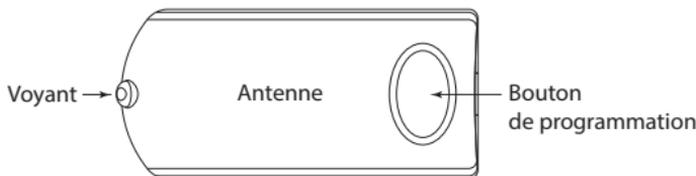
L'antenne, généralement située sur la partie supérieure du pare-brise avant, envoie et reçoit des commandes ou des messages du système et vers celui-ci. Elle est constituée du :
