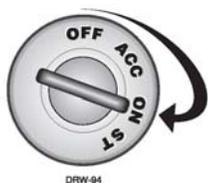
Pour désarmer le système de sécurité, tournez la clé de contact à la position "ON". Appuyez et relâchez l'interrupteur à bouton poussoir Valet dans l'espace de 10 secondes. Le système devrait se désarmer et le témoin lumineux à DEL devrait arrêter de clignoter. Si celui-ci ne se désarme pas; tournez la clé de contact à la position "OFF" et reprenez les étapes depuis le début.
