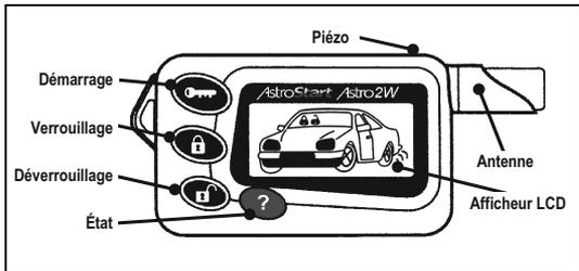
La télécommande émet une tonalité (basse) au début de la transmission puis émet une seconde tonalité (aiguë) à la fin de la transmission soit environ 2 seconde après que le bouton ait été enfoncé.
